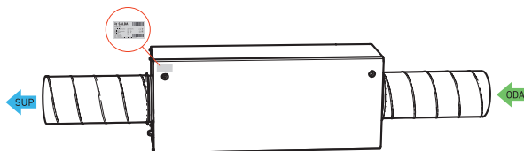
Рисунок 2.4. Расположение технической этикетки и индикация воздушного канала AmberAir Compact VEKA INT 400-700 E EKO
