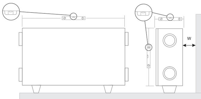
Figure 5.5.1. Positions horizontales de montage au sol ( $l = 400$  mm)
