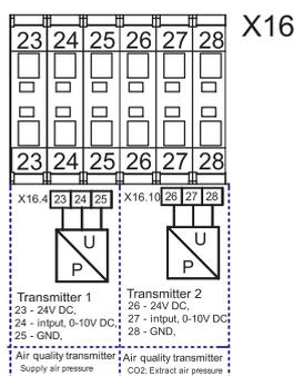
Ces capteurs sont prévus pour les 3 fonctions suivantes: la pression de l'air soufflé, la pression de l'air repris et la détection de CO<sub>2</sub> extrait. La pression de l'air soufflé est mesurée à l'intérieur de la gaine d'arrivée d'air en référence à l'environnement de l'unité. La pression de l'air repris est mesurée à l'intérieur de la gaine d'extraction en référence à l'environnement de l'unité. Le transmetteur de CO<sub>2</sub> est installé dans la gaine d'extraction ou dans le local.
