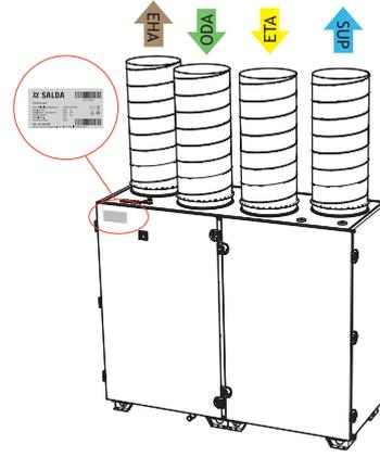
Abbildung 3.3.6 Platzierung Typenschild und Luftkanalanschluss AmberAir Compact S-CX V (rechte Seite)
