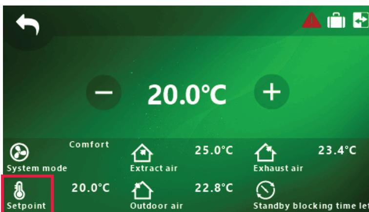
Abbildung 5.6.1.4 Bildschirmsicht ST-SA-Control und SALDA AIR Temperatursollwert
