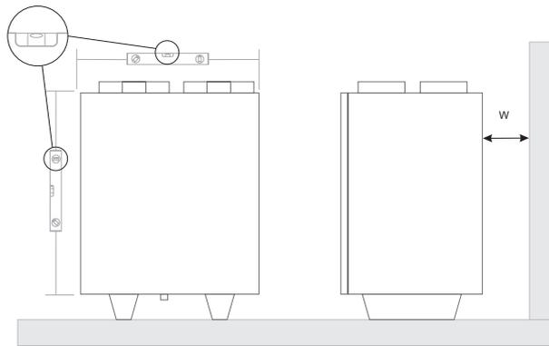
Abbildung 5.5.1. Montageposition: Horizontal Boden ( $W=400\text{mm}$ )
