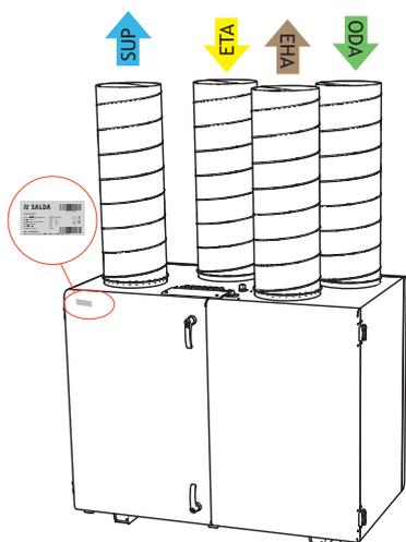
Abbildung 2.3. Platzierung Technischer Aufkleber und Luftkanalanschluss AmberAir Compact RIRS 1200-1900 V EKO 3.0 (rechte Seite)
