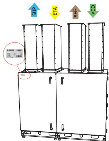
Abbildung 2.5. Platzierung Technischer Aufkleber und Luftkanalanschluss AmberAir Compact RIRS 2500-3500 V EKO 3.0 (rechte Seite)
