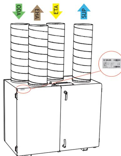
Abbildung 2.4. Platzierung Technischer Aufkleber und Luftkanalanschluss AmberAir Compact RIRS 1200-1900 V EKO 3.0 (linke Seite)
