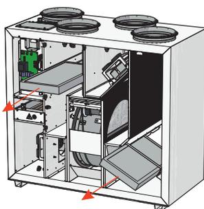
Öffnen Sie die Türen des Geräts und entnehmen Sie die Filter.
