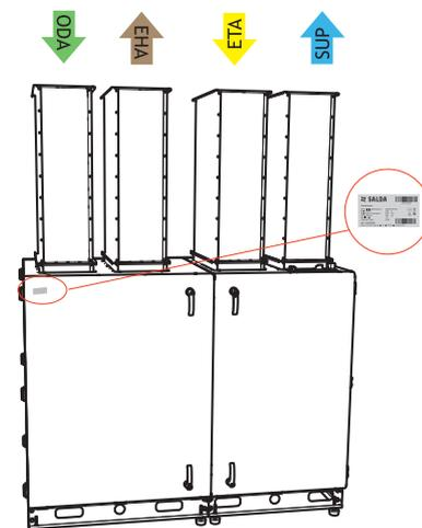
Abbildung 2.6. Platzierung Technischer Aufkleber und Luftkanalanschluss AmberAir Compact RIRS 2500-3500 V EKO 3.0 (linke Seite)
