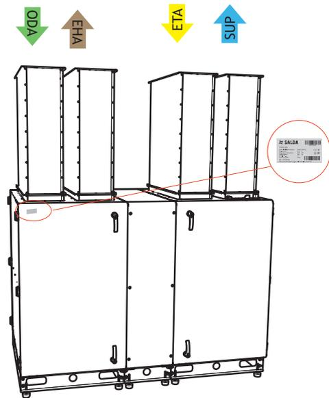
Figure 2.8. Emplacement de l'étiquette signalétique et indication de raccordement des gaines AmberAir Compact RIRS 5500 V EKO 3.0 (Côté gauche)
