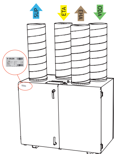
Figuur 2.3. Kentekenplaatje en aanwijzing kanaalaansluiting AmberAir Compact RIRS 1200-1900 V EKO 3.0 (rechterzijde)
