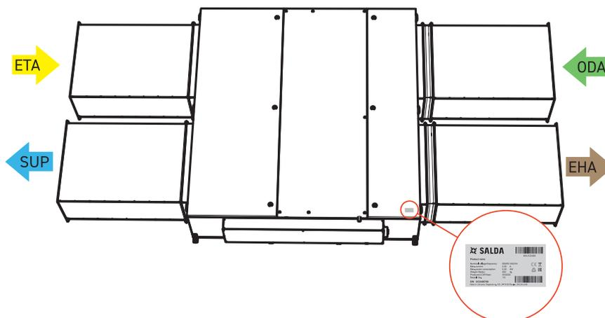
Abbildung 2.3. Platzierung Technischer Aufkleber und Luftkanalanschluss
