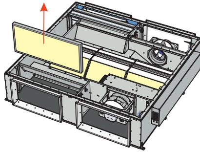
Öffnen Sie die Türen des Geräts und entnehmen Sie die Filter. Verschmutzungen erhöhen den Luftstromwiderstand der Filter, dadurch wird der Luftstrom in die Räumlichkeiten verringert. Die Pfeile auf den Filtern müssen mit der Luftstromrichtung übereinstimmen.
