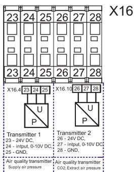
Die Sensoren sind für die folgenden 3 Funktionen bestimmt: Zuluftdruck, Abluftdruck und Abluft CO<sub>2</sub>.
