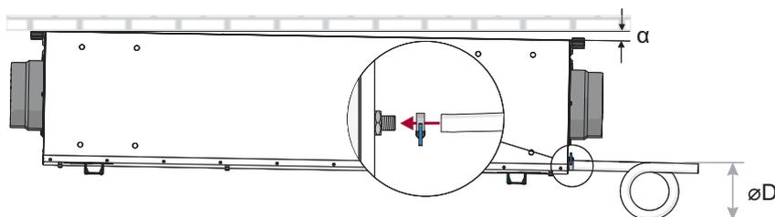
Abbildung 5.5.2.2. Anschluss Kondensatablauf (øD=150 mm)
