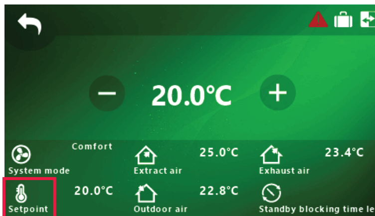
Abbildung 5.6.1.4 Bildschirmsicht ST-SA-Control und SALDA AIR Temperatursollwert
