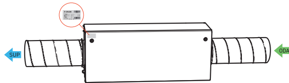
Abbildung 2.4 Platzierung Technischer Aufkleber und Luftkanalanschluss AmberAir Compact VEKA INT 400-700 E EKO
