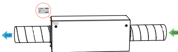
Pav. 2.4 Techninio lipduko vieta ir oro kanalų žymėjimas AmberAir Compact VEKA INT 400-700 E EKO
