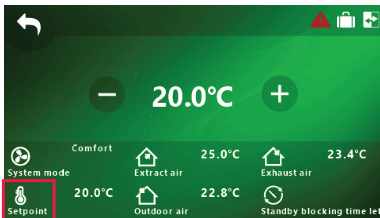
Fig. 5.6.1.4 Vue de l'écran du point de consigne de la température de la commande ST-SA-Control et de l'appli SALDA AIR
