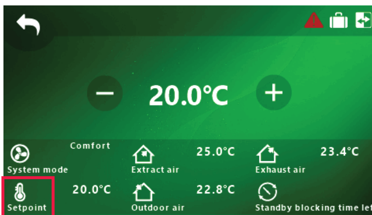
Afb. 5.6.1.4 Schermweergave ST-SA-Control en SALDA AIR temperatuur instelpunt
