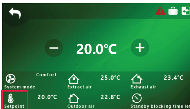
Fig. 5.6.1.4 Widok ekranu ustawień temperatury ST-SA-Control i SALDA AIR
